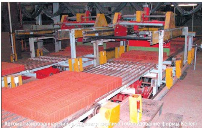
Автоматизированная линия укладки кирпича (оборудование фирмы Keller)
